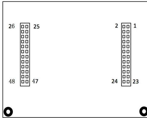
图-2 模组 PIN 脚定义
